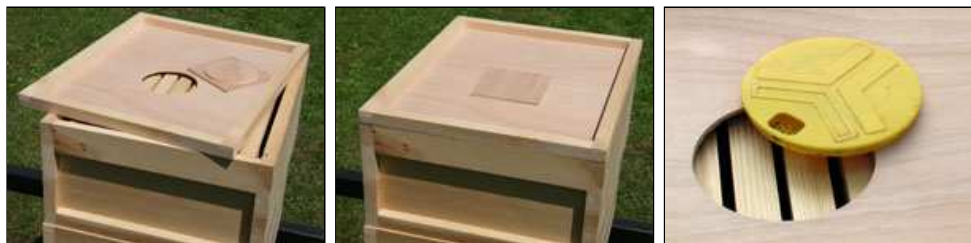
Innendeckel mit 20 mm innerer Tiefe und Holzdeckel. Die kreisrunde Öffnung mit 114 mm Durchmesser kann eine Bienenflucht aufnehmen oder mit einem Holzdeckel verschlossen werden.
